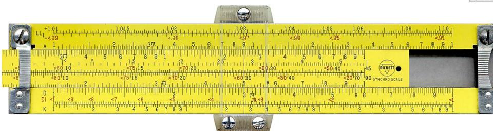
Figura 6. Multiplicación 2: Se va a multiplicar  $6 \times 5$ . Situamos el 10 de la escala C sobre el 6 de la escala D. A continuación desplazamos el cursor al 5 de la escala C. En la escala D leemos el resultado, en este caso 3. Como se ha utilizado el 10 de la escala C y no el 1, el resultado obtenido hay que multiplicarlo por 10, con lo que el resultado final es 30 (Imagen realizada en el simulador [8])
