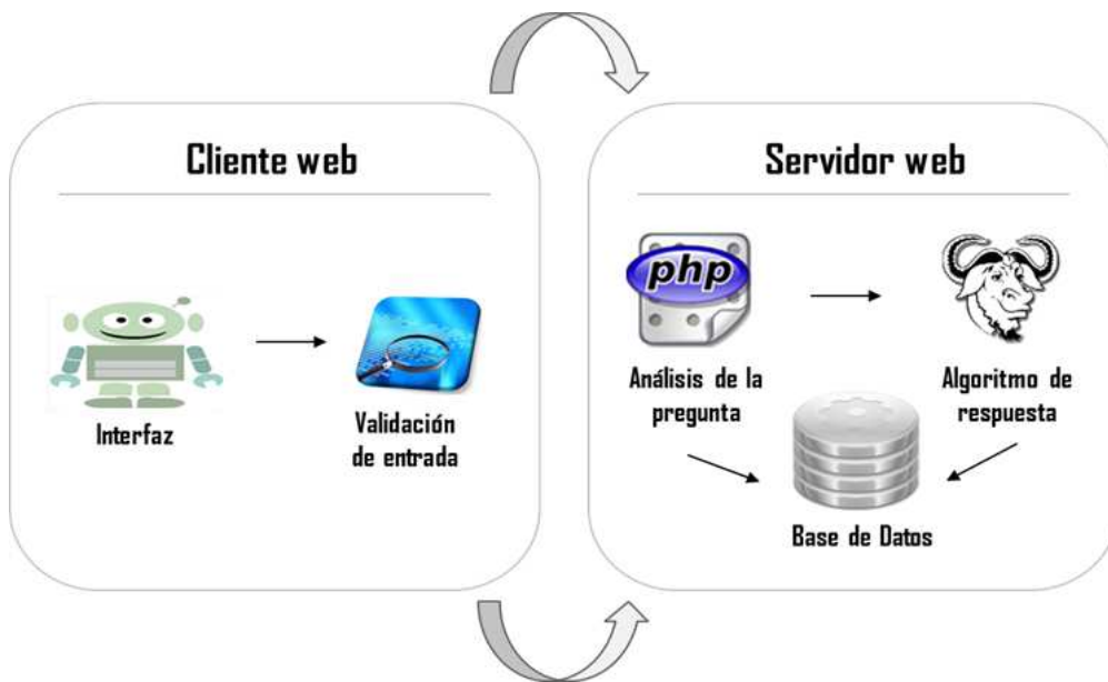
Figura 1. Arquitectura específica del sistema
