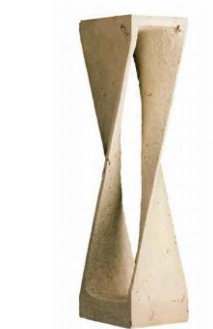
Figura 10. Pedra de toc 3 . Medidas b 20 \times 20 \times h 50 mm. Piedra calcárea de la Mola
