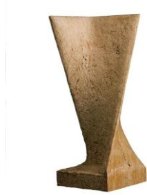
Figura 9. Pedra de toc 2 . Medidas b_{20} \times 20 \times h 50 mm. Piedra calcárea de la Mola
