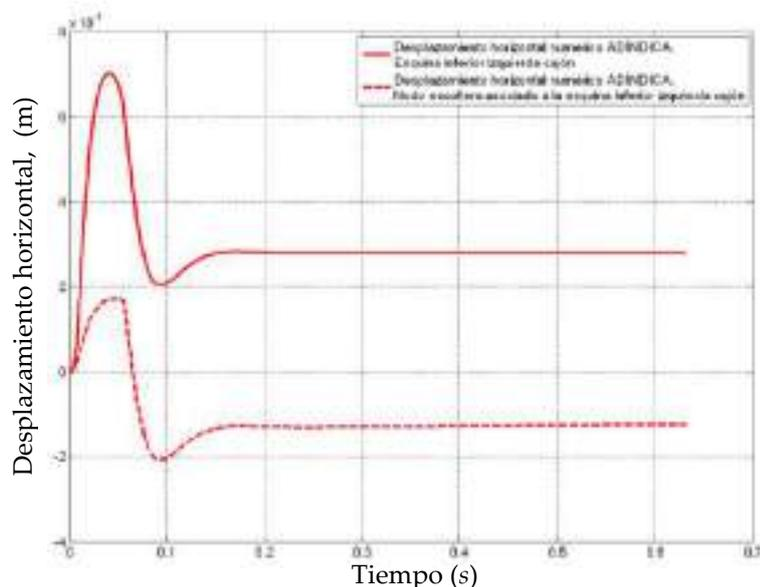
Figura 19 Comparación entre el desplazamiento horizontal registrado en la esquina inferior derecha del cajón y el nodo de la escollera más próximo a la esquina inferior derecha del cajón.
