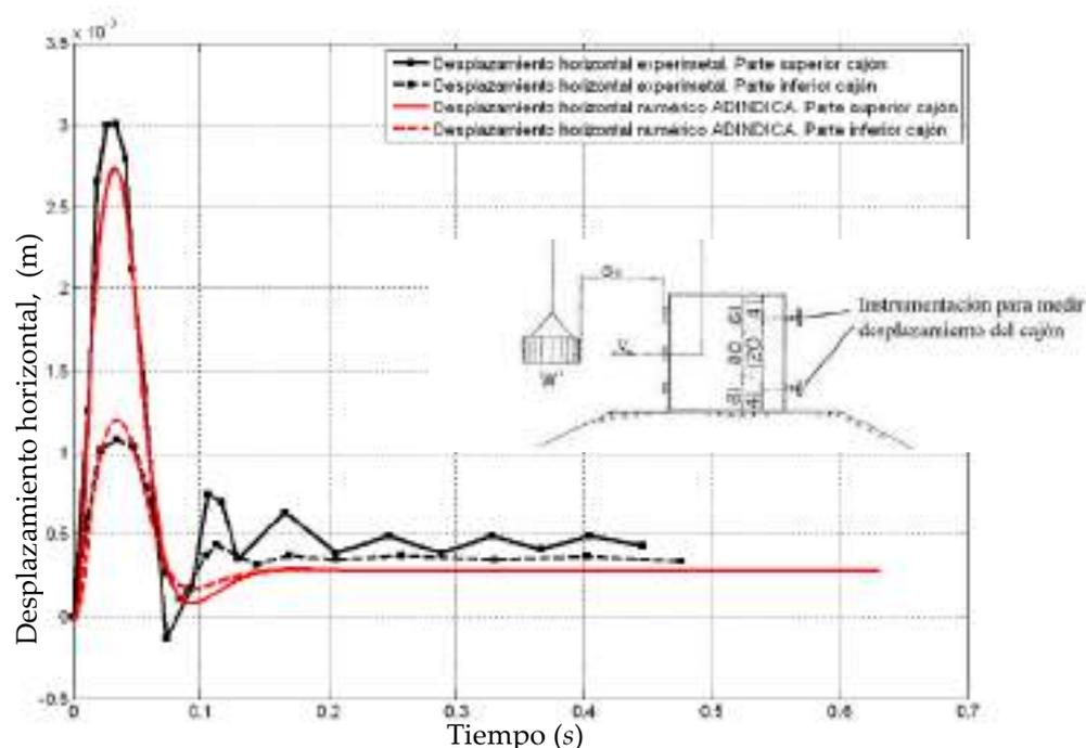
Figura 18. Comparación entre los resultados numéricos y los datos experimentales obtenidos por Goda en 1994. Desplazamientos horizontales del cajón.
