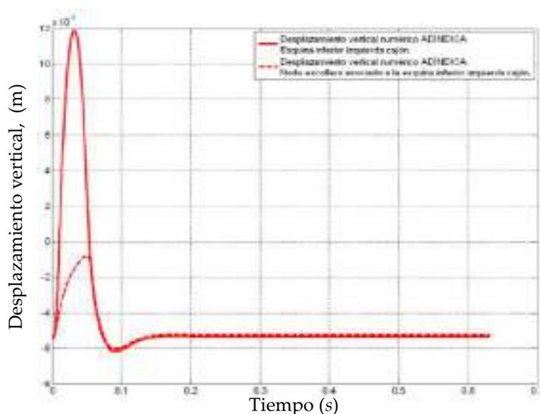
Figura 21. Comparación entre el desplazamiento vertical registrado en la esquina inferior derecha del cajón y el nodo de la escollera más próximo a la esquina inferior derecha del cajón.
