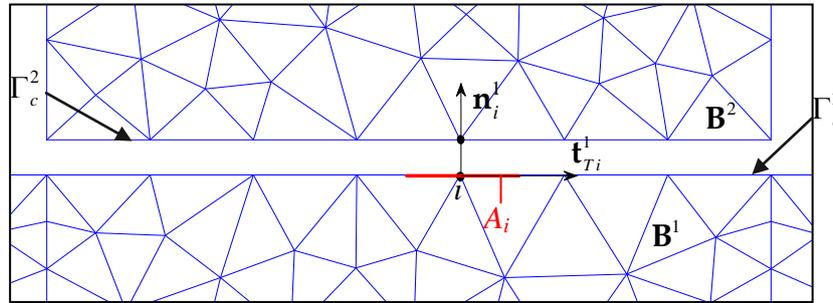
Figura 11. Elemento de contacto nodo a nodo
