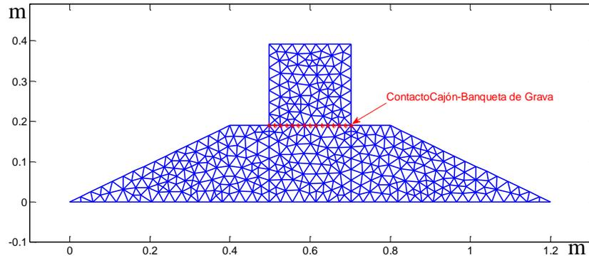
Figura 14. Malla de elementos finitos empleada en la simulación numérica
