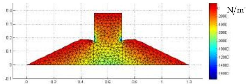
Figura 17 Isótopas de tensión vertical registradas en banqueta de grava y cajón tras colocar el cajón. Resultado numérico.
