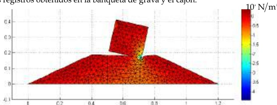
Figura 22. Isolíneas de tensión vertical registradas en la banqueta de grava y el cajón tras el impacto del péndulo. Instante de tiempo  $t=0.032\text{s}$ . Resultado numérico.
