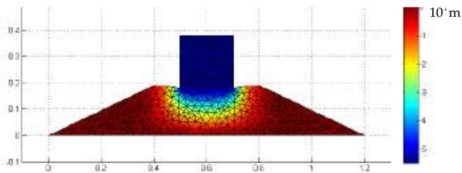
Figura 16 Isótopas de desplazamiento vertical tras apoyar el cajón sobre la banqueta de grava. Resultado numérico.
