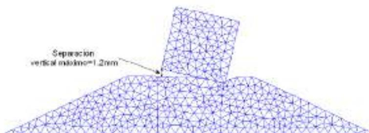
Figura 20 Deformada en el instante  $t=0.032s$ , máximo desplazamiento horizontal. Resultado numérico.
