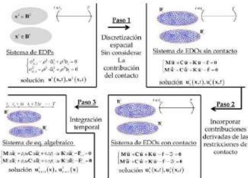
Figura 10. Procedimiento de resolución de un problema de contacto a través del Método de los Elementos Finitos
